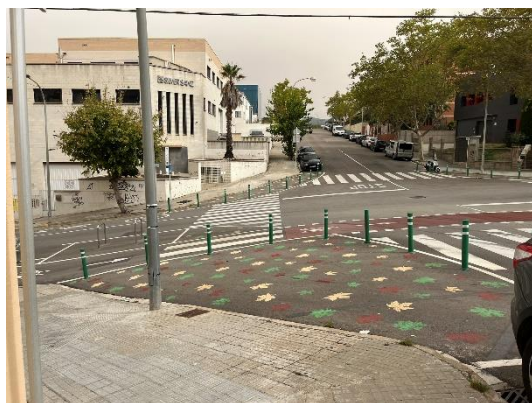
Imatge 16. Carre Juan de la Cierva amb carrer Pere Ponce de León, itinerari per a vianants ampliat amb orelles
