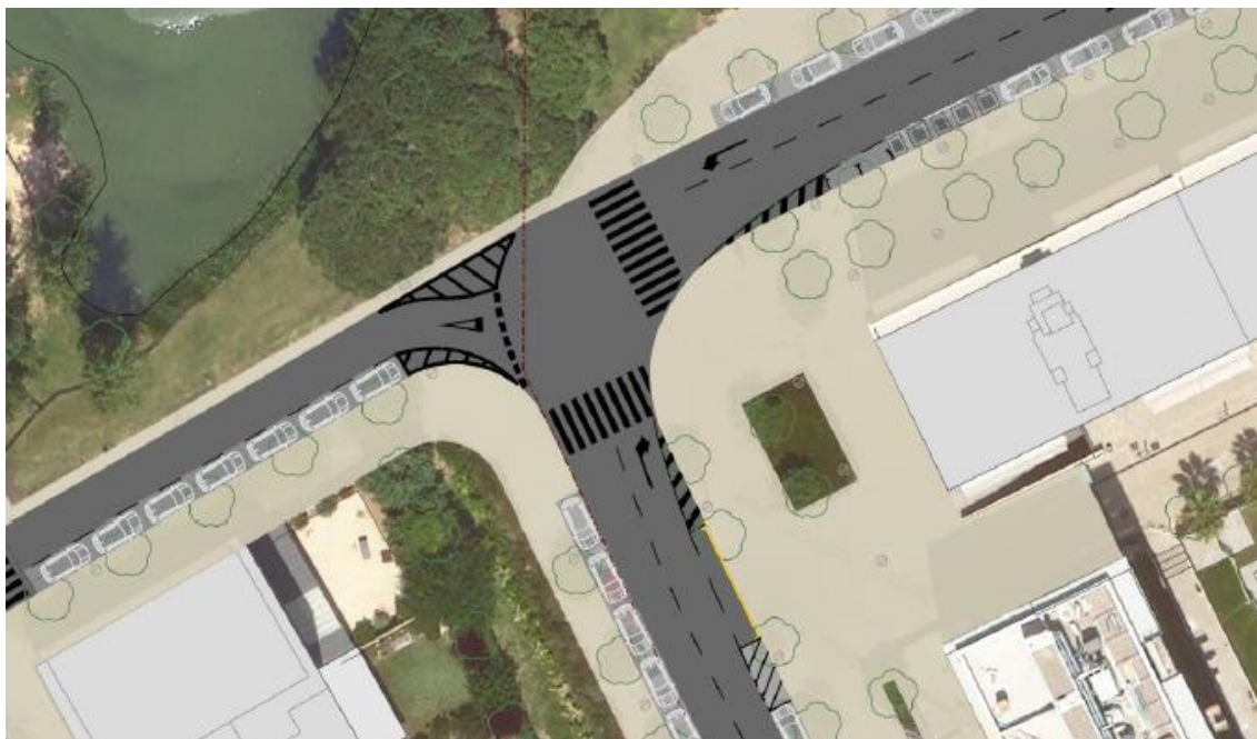
Figura 36. Prova de gir d'autobusos a la nova configuració de la cruïlla
