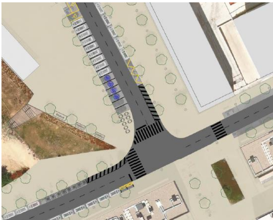
Figura 39. Prova de gir d'autobusos a la nova configuració de la cruïlla
