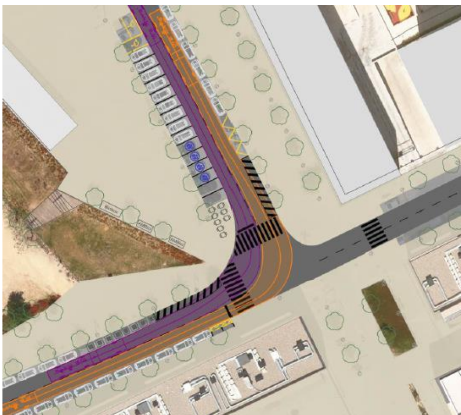
Figura 39. Prova de gir d'autobusos a la nova configuració de la cruïlla
