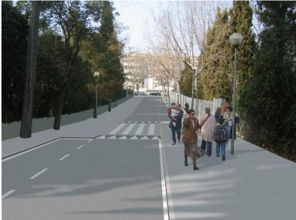
Imatge 76. Carrer amb sentit únic i aparcament alternatiu, que permet l'ampliació de voreres
