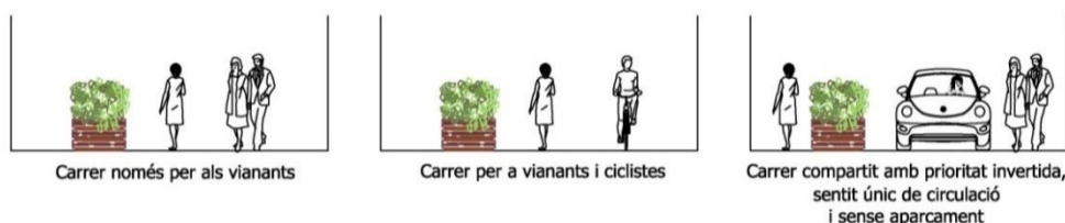
Figura 44. Possibles seccions per a carrers amb menys de 7 m d'amplada
